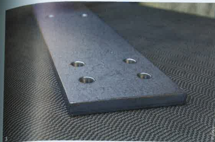
3 Der »Edgebreaker 4000« bearbeitet bei Nägele typischerweise Teile wie dieses mit einer Stärke von 25 Millimetern. Pro Jahr laufen 1.000 Tonnen Stahl über das Band der Entgratmaschine.
